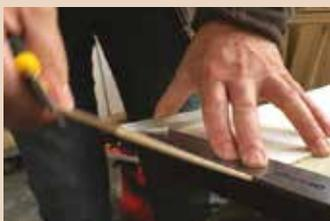
Découper les lames de bois à la scie radiale, à la scie à denture fine, ou au cutter.
