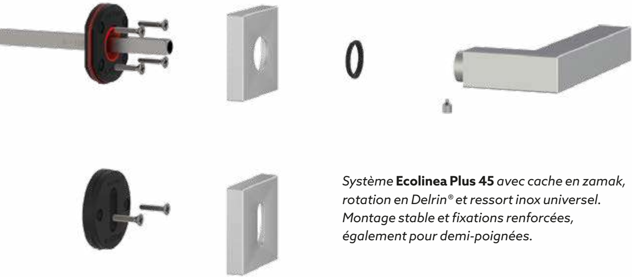
Schéma de montage du système PLUS 45 (valable pour tous les modèles Premium )
